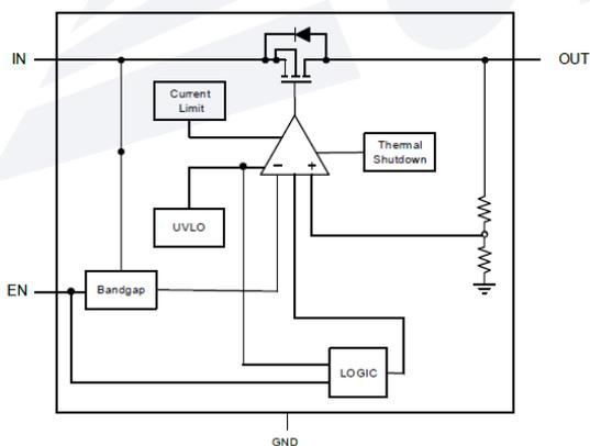
输出电压通过连接到误差放大器正相输入端的分压电阻采样，误差放大器的反相输入端连接到一个参考电压  $V_{ref}$  (bandgap)。输出电容除了提供电容本身外，在系统中还会体现一个等效串联电阻 (ESR)，而该 ESR 会系统中产生一个零点，零点频率 (FZERO) 与 ESR 及电容值密切相关如公式 1)。
